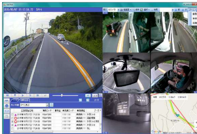
図 ドライブレコーダー解析ソフトの例 矢崎エナジーシステム(株)
