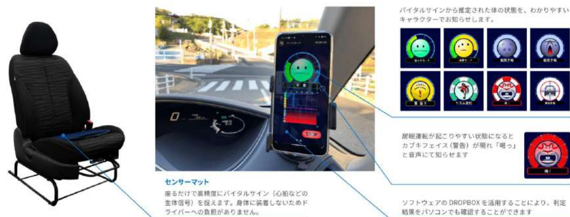
図 眠気等の体調の急変を感知する機器の例
